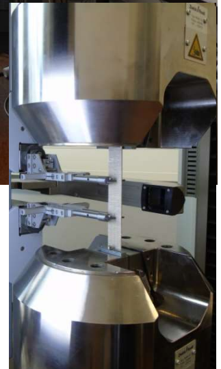
multiXtens Längenänderungs- aufnehmer mit videoXtens Querdehnungs- aufnehmer
