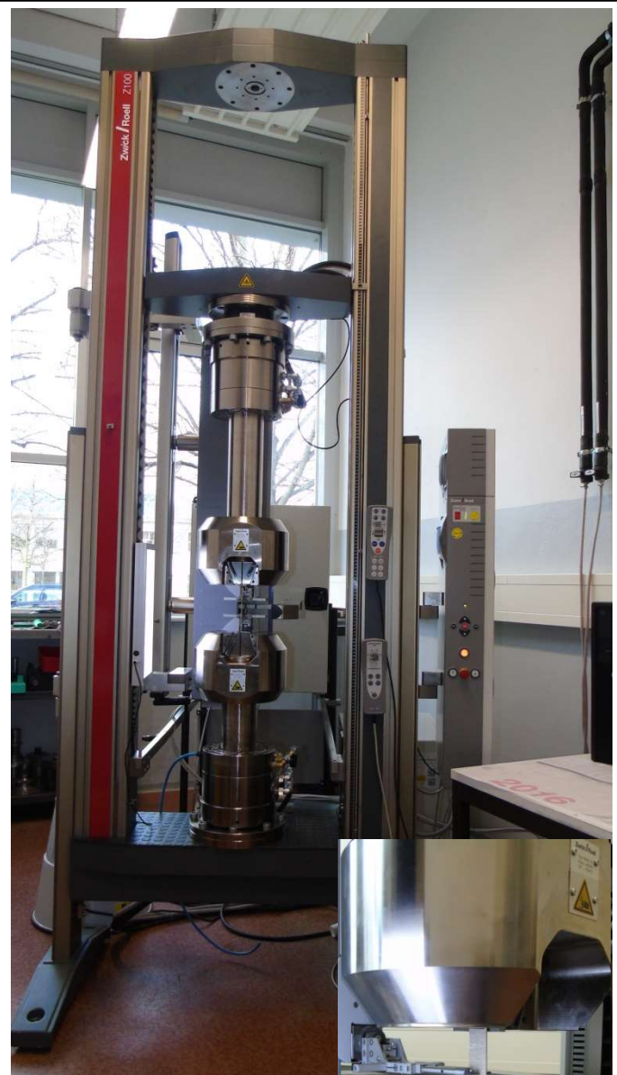
multiXtens Längenänderungs- aufnehmer mit videoXtens Querdehnungs- aufnehmer
